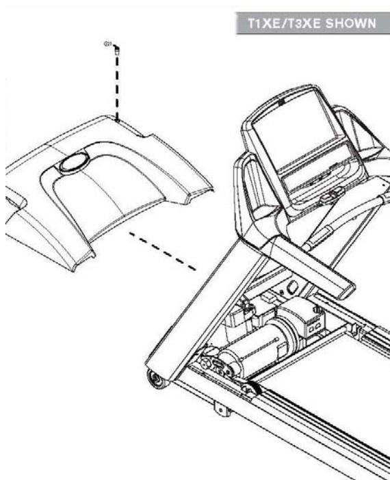
1. Закрепите крышку мотора.
